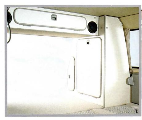
1. Kleiderschrank und Dachstaukasten im Fahrzeugheck Kleider-/Wäscheschrank mit seitlicher Klappe und kleiner Tür zum Einbau links auf dem Motorraum
