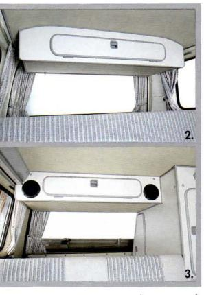
3. Lautsprecher-Ausstattung im Dachstaukasten 2Einbau-Lautsprecher 15W mit verdeckter Verkabelung zum Radio im Fahrerhaus (nur Erstausrüstung).
