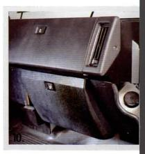
10. Zusätzliches Handschuhfach Zur Montage unter dem Original-Handschuhfach im VW-LT, einschließlich der seitlichen Verkleidung.
